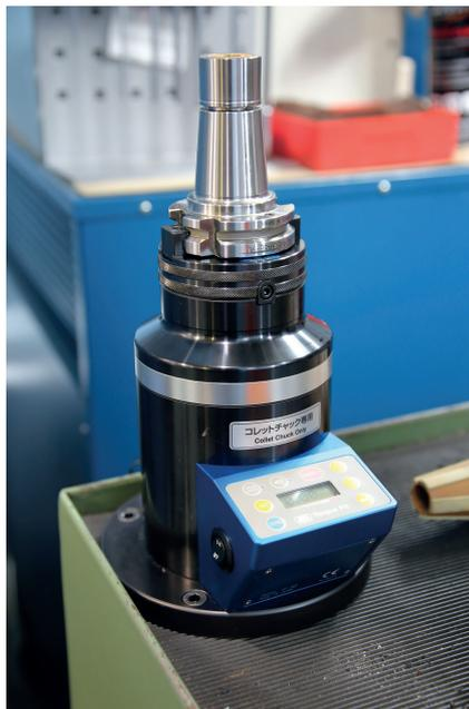
**2** Torque Fit, eine Werkzeug-Montagestation für Spannzangenhalter mit einem eingebauten Drehmoment-Messgerät, erleichtert das präzise Festziehen von Spannzangenhaltern. Die Drehmomentwerte sind voreingestellt © BIG Daishowa
